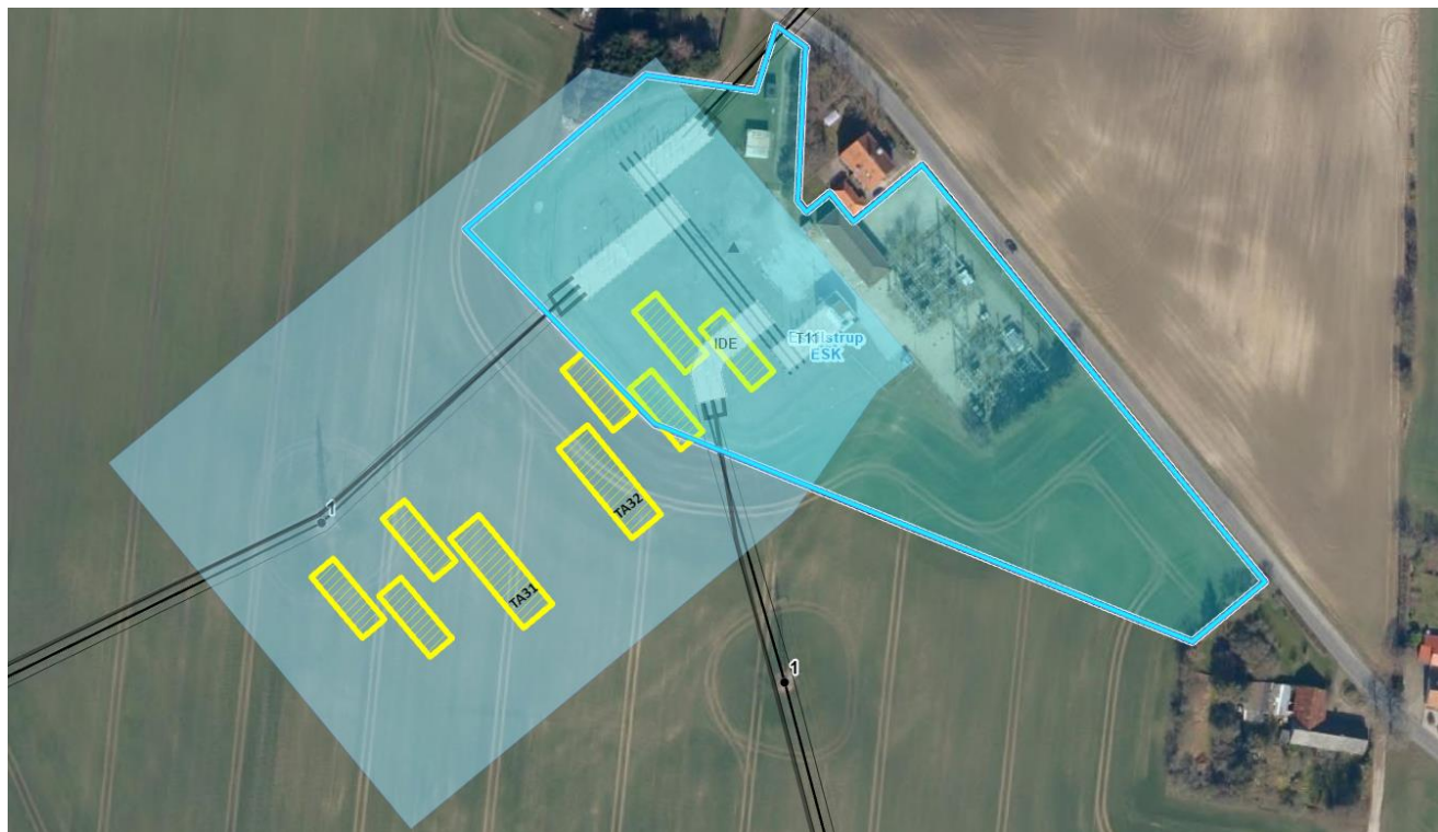
Figur 4.1: Station Eskilstrup. Nye anlæg markeret med gult..
